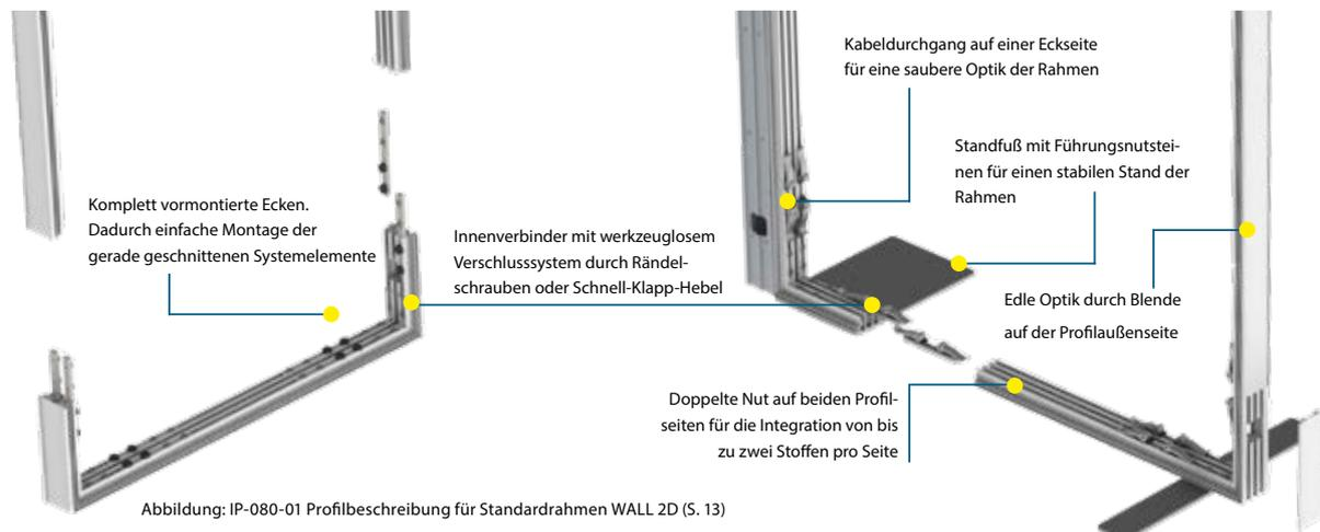
Abbildung: IP-080-01 Profilbeschreibung für Standardrahmen WALL 2D (S. 13)
