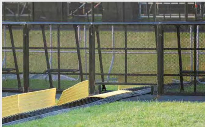
Integrierte Kabeldurchlässe (z.B. Multicore) bei Open Air Veranstaltung
