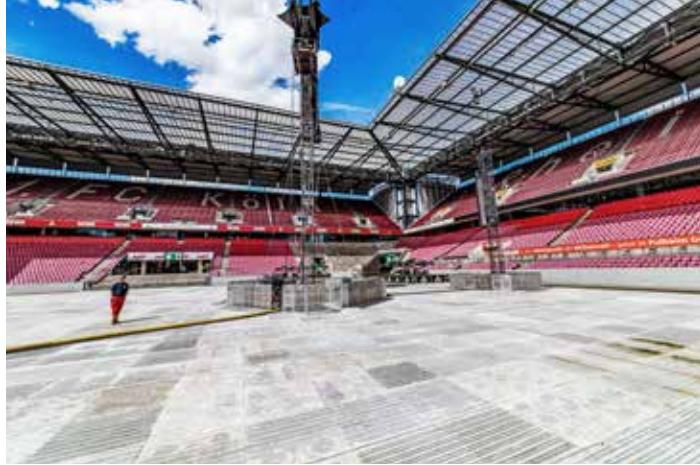
**Terraplas** eignet sich hervorragend für eine längere Abdeckung von ebenem Gelände – ob in Fußball-, in Eisstadien oder auf flachen Golfplätzen. Abhängig von den Witterungsverhältnissen bietet das System Grasflächen für eine Dauer von bis zu sieben Tagen optimalen Schutz.
