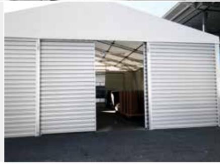
Schiebetore bestehen aus Stahlrahmen, Füllung mit PVC-Plane, Trapezblech oder Sandwichplatten, Öffnen und Schließen erfolgt horizontal, Schiebeelemente ein- oder zweiflügelig verfügbar
