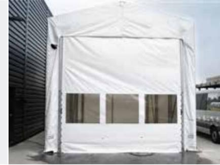
PVC-Planenvorhang, Breite bis 12 m, Höhe bis 6 m, Oberhalb in Führungsschienen und Rollensystem, Öffnen und Schließen erfolgt horizontal über Seilzugmechanik
